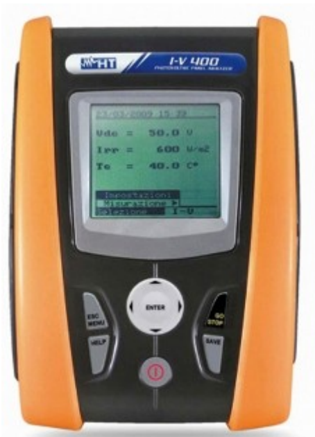
Abb. 1: Stand der Technik - Kennlinienmessgerät für den mobilen Einsatz (Quelle: HT Instruments)
