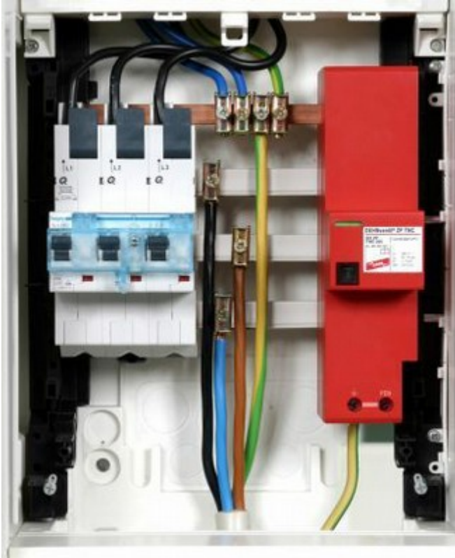
Abb. 3: Kombi-Ableiter Typ 1 mit einem Ableitvermögen von 100 kA (10/350), geeignet zum Einsatz auf dem 40 mm-Sammelschienensystem am Zählerplatz (Pos. 3 im Bild 2) (Quelle: Dehn + Söhne, www.dehn.de )
