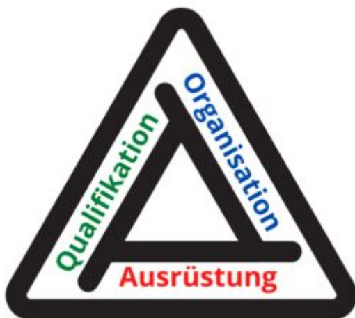
Die drei Säulen beim Arbeiten unter Spannung
