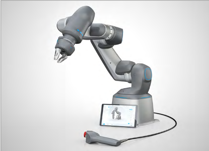
Pneumatischer Roboter: der Festo Cobot ist leicht zu bedienen und kommt ohne Schutzzaun aus. (© Festo SE & Co. KG)
