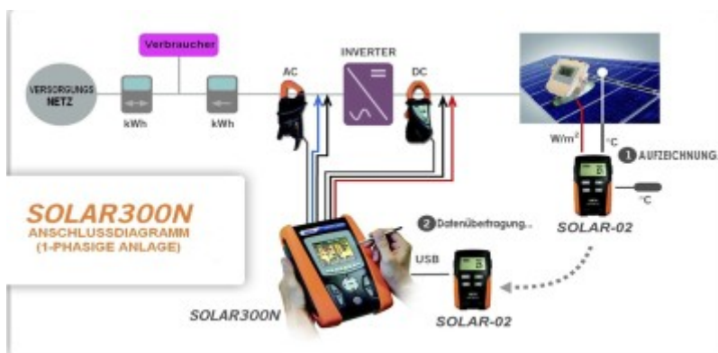
Abb. 2: Typischer Messaufbau zur Live-Messung des Wechselrichter-Wirkungsgrads bei PV-Anlagen (Quelle: HT Instruments)
